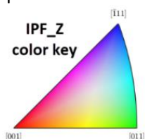
Fig. 1.3.1. Reprezentarea codului de culoare pentru figurile inverse de pol – IPF în raport cu axa Z a sistemului de axe cristalografice.
