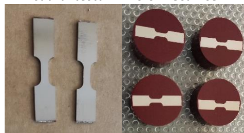
Fig. 17. Aspectul probelor pentru testarea micro-mecanică in-situ (înainte și după etapa de pregătirea metalografică).
