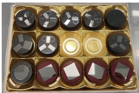
Fig. I.5.2. Aspectul probelor înglobate / șlefuite-lustruite utilizate în analiza caracteristicilor microstructurale pentru aliajul UNS S32750.
