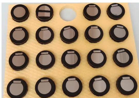
Fig. 4.6. Aspectul probelor înglobate / șlefuite-lustruite utilizate pentru punerea în evidență a evoluției faze, la încălzire, a aliajul UNS S32750.
