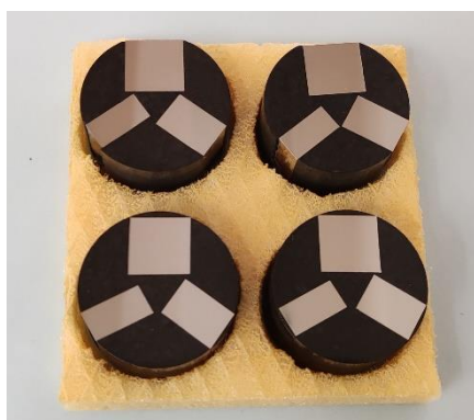
Fig. 4.7. Aspectul probelor înglobate / șlefuite-lustruite utilizate pentru punerea în evidență a microstructurii în timpul etapelor de deformare plastică la cald.
