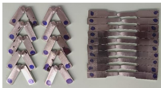
Fig. I.3.5. Set de probe folosite în cadrul testelor de reziliență și tracțiune.
