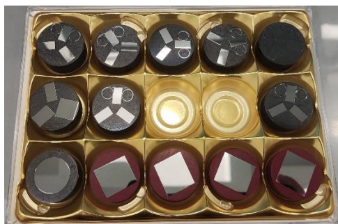
Fig. I.3.2. Aspectul probelor înglobate / șlefuite-lustruite utilizate în analiza caracteristicilor microstructurale pentru aliajul UNS S32750.
